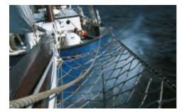
Die Stortemelk ist ein umgebauter Fischkutter mit drei Vorsegeln, einem Gaffelsegel und einem Großsegel als Dreieckssegel. Beim An- und Ablegen, Ankern, Segelsetzen und -bergen, Wenden und Halsen gibt es einiges zu tun. Die Stortemelk ist darauf eingestellt, dass sämtliche Arbeiten von den Gruppen ausgeführt werden – natürlich unter entsprechender Anleitung.
